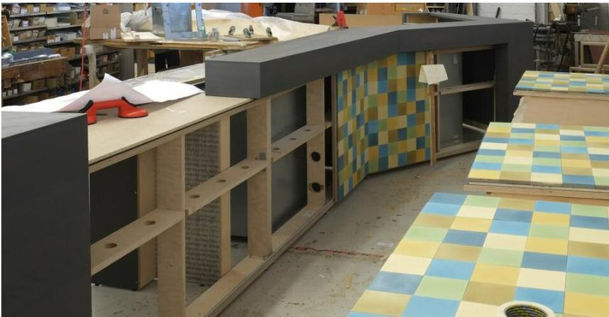
Abnehmbare Fronten erlauben die schnelle Montage aller Installationsgewerke
