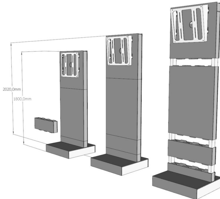
Der sehr stabile Ständer ist für vielfachen Auf- und Abbau konzipiert. Die Elemente trennen sich in gliedernden Fugen. Zerlegte Einzelteile stehen auf Zapfen, sodass sie keinen Schaden nehmen. Stellfüße geben einen wackelfreien Stand. Auch Dreiersteckdosen finden noch im Sockel Platz.
