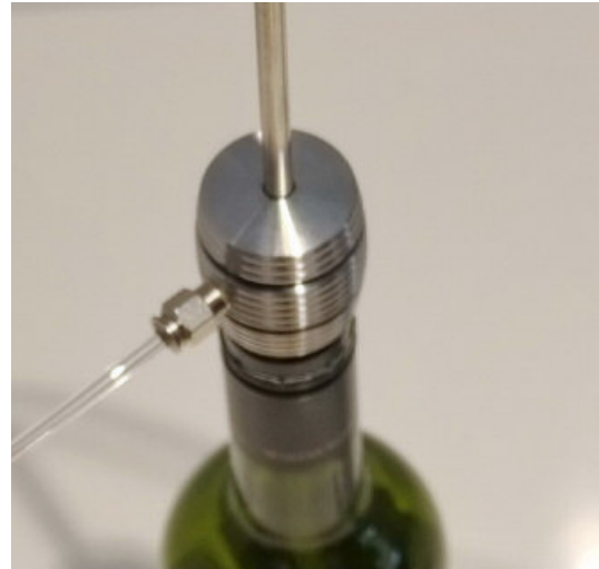
Ein Druck von oben auf die Armatur lässt das Gas in die Flasche strömen und die Flüssigkeit steigt im Edelstahlröhrchen auf.
